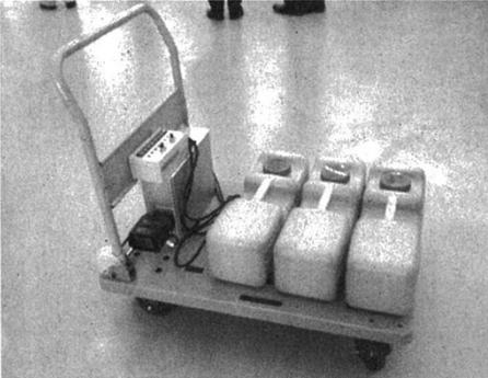
インテリジェントアシスト駆動ユニットを搭載した台車
